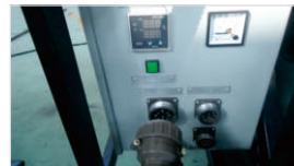
Sambungkan kabel dan plat pemanas
